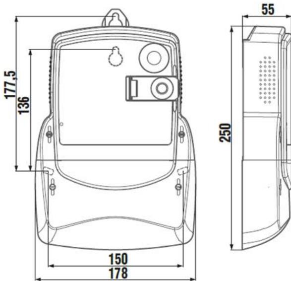
Kompaktes Gehäuse aus selbstlöschendem Polycarbonat
